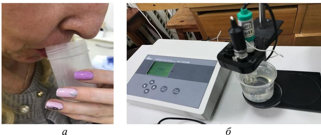
Рисунок 19 – рН исследование: а) сбор ротовой жидкости; б) иономер И-160М
